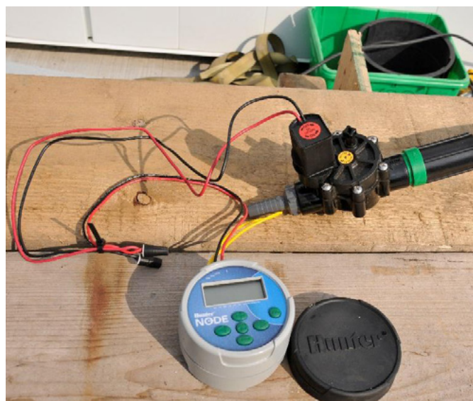
Figure 19 – Exemple de minuteur électronique pour contrôler la fréquence d'arrosage.
