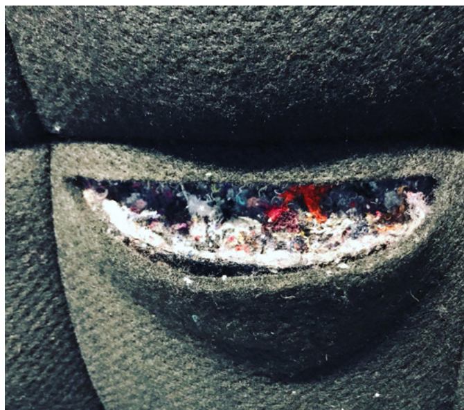
Figure 16 – Fibres dans une poche de géotextile servant de substrat de croissance à l'aéroport de Schipol.
